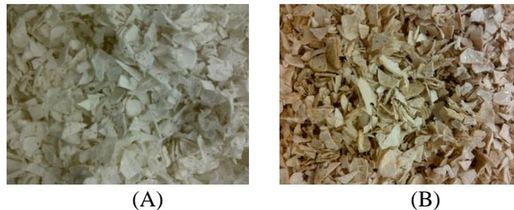
Figura 1 - Residuo de un embalaje de alimento hecho de papel cartón con PET (A) y después del calentamiento.
