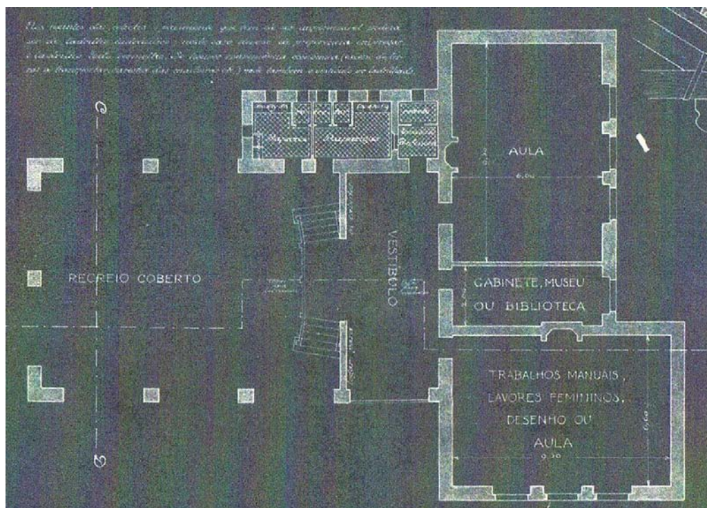
Figura 2. Planta do modelo de escola primária mista para 50 alunos, tipo norte, Raul Lino, 1918. (Fonte: Fundação Calouste Gulbenkian, Espólio Raul Lino, 60.0).
