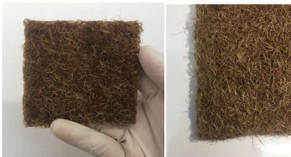
Figura 16: Tecido não-tecido com fibras de açaí consolidadas
