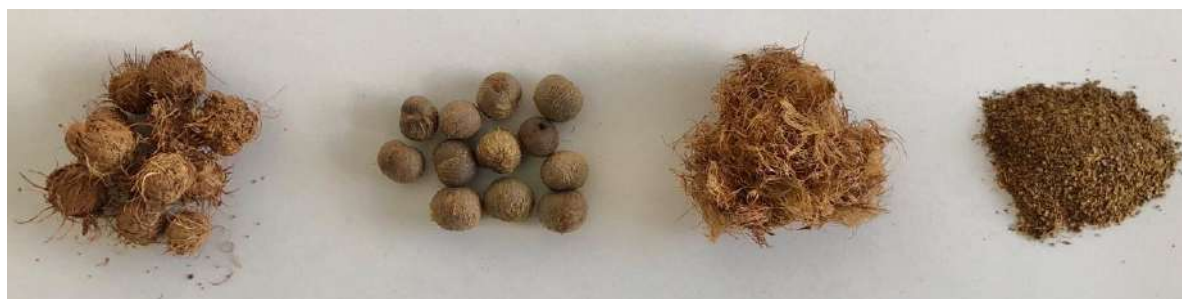
Figura 04: Resíduos mistos; caroços; fibras e borra de açaí - respectivamente
