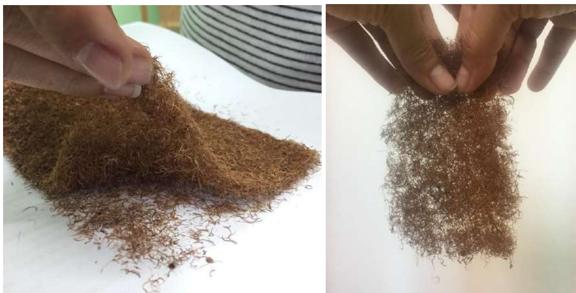
Figura 14: Manta desintegrada após manuseio
