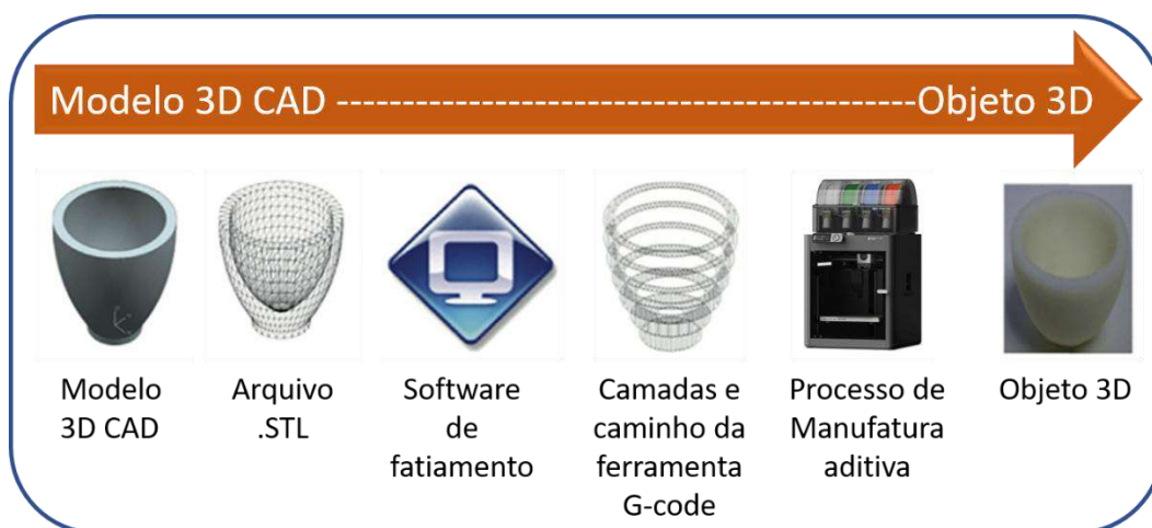
Figura 1 – Fluxo Geral do Processo de Manufatura aditiva ou Impressão 3D
