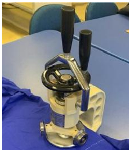
Figura 4: Corte do corpo-de-prova utilizando o cortador circular
