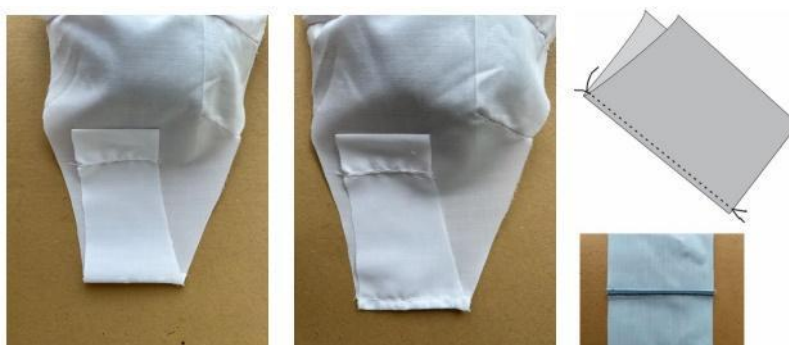
Figura 18 - Costura francesa finalizada, diagrama e amostra da costura ponto atrás.
