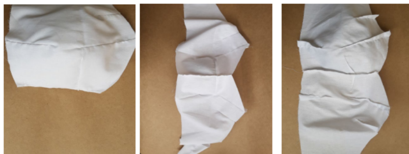
Figura 19 - Costura de união do meio da frente do protótipo do sutiã.
